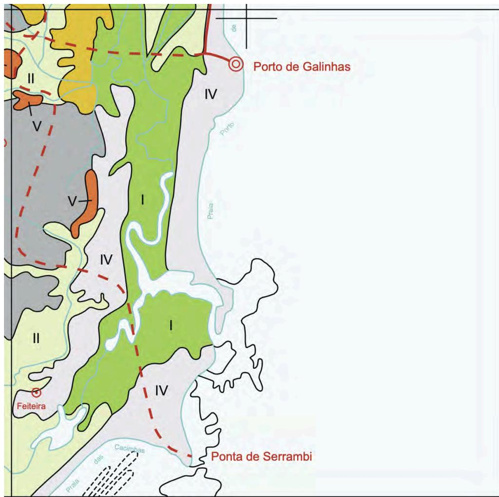
Figura 37. Detalhe da carta geotécnica e de suscetibilidade á processos geológicos do município de Ipojuca-PE produzida pela CPRM em parceria com a FIDEM. Fonte da imagem: PFALTZGRAFF (1998).
